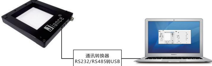
GK-NA-80框型计数传感器带RS232/RS485串口通讯功能，可以通过上位机向传感器发送指令，及读取传感器当前的参数。可读写的功能包括：物体尺寸上下限设置、输入信号上升/下降沿确认时长、滤波功能、输出脉冲宽度设置、输出常开/常闭设置、自学习设置、恢复出厂设置等。
