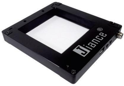
JC-NA-80 框型计数传感器是利用光电对射原理，将红外光布满整个框体检测区域。当有微小半透明或不透明的小物体经过检测区域时，接收端收到的光强会减弱，得到的信号也会变弱，从而实现检测功能。JC-NA-80 框型计数传感器具有很高的灵敏度，最小检测物可达到  $\Phi 1\text{mm}$ 。JC-NA-80 常用于检测小零件、金属或非金属部件的计数、冲压厂中监控工作的弹出或移除。
